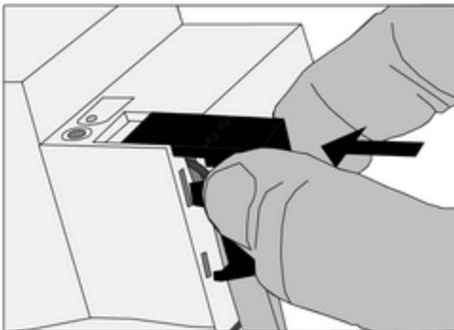
Figure 6: Mise en place du capuchon de protection
