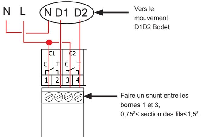
**⚠** Pour les circuits relais, prévoir une protection par sectionneur-fusible ou disjoncteur 4A maximum. Indiquer sur l'étiquette bornier la localisation de ces protections.
