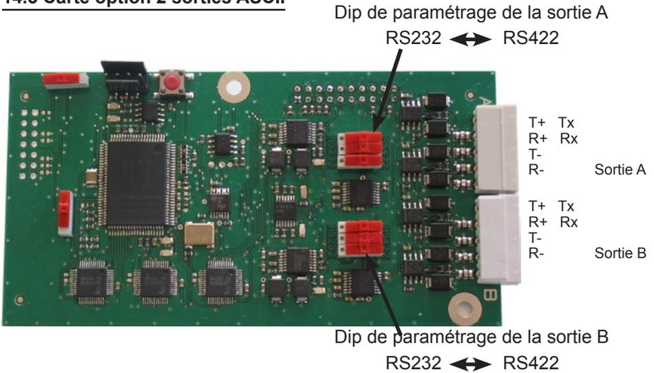
Cette carte option possède 2 sorties ASCII qui peuvent être configurées en RS232 ou RS422 (RS485). Pour changer de configuration, pousser les 3 Dips dans la position souhaitée.
