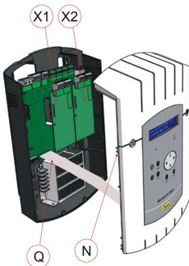
**Version RACK :** Ouvrir le boîtier rack et installer la ou les cartes options dans les emplacements prévus (X1) et (X2).
