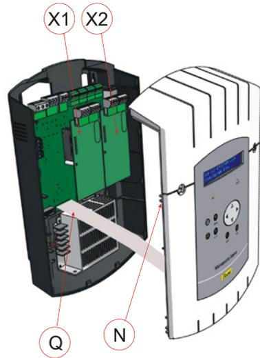
**Version RACK :** Ouvrir le boîtier rack et installer la ou les cartes options dans les emplacements prévus (X1) à (X4).
