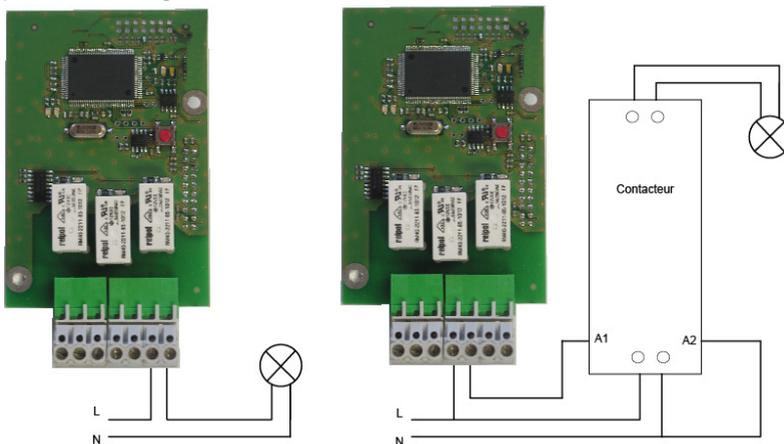
**⚠** Pour les circuits relais, prévoir une protection par sectionneur-fusible ou disjoncteur 4A maximum. Indiquer sur l'étiquette bornier la localisation de ces protections.
