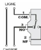
Quand le flussostat est utilisé pour activer un dispositif **en présence de débit**
