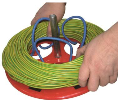
Das Drahtcoil einsetzen
