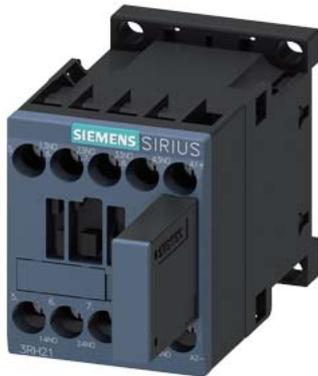
Contacteur auxiliaire de couplage, 4 NO, 24V CC, 0,85 ... 1,85\* US, avec varistance enfichée, Taille S00, borne à vis
