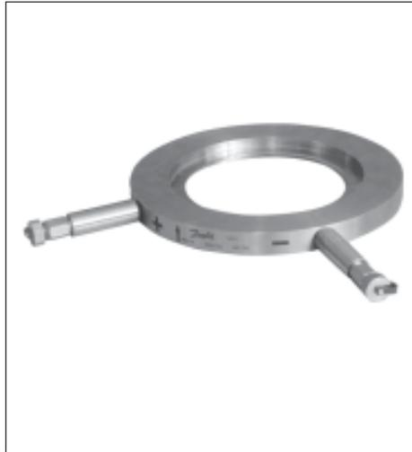
Les diaphragmes en inox de Danfoss sont utilisées dans les systèmes de chauffage et de réfrigération pour des lectures précises du débit. Pratiquement, la valeur est « calculée » avec la perte de charge mesurée dans la diaphragme (calibrée sur une valeur  $k$  très précise) et le débit mesuré avec un PFM 4000 ou avec un autre appareil de mesure de débit.
