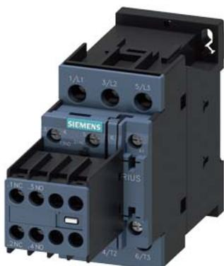
Contacteur de puissance, AC-3 : 12 A, 5,5 kW / 400 V 2 NO + 2 NF, AC 24 V, 50/60 Hz 3 pôles, Taille S0 borne à vis Interrupteur auxiliaire amovible
