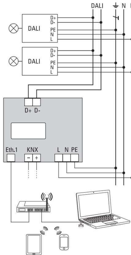
Una volta completati tutti i collegamenti e dopo aver inserito l'alimentazione, sul display appaiono il nome del prodotto e la versione del firmware. Ora è possibile mettere in funzione la linea DALI e procedere alla programmazione con ETS.
