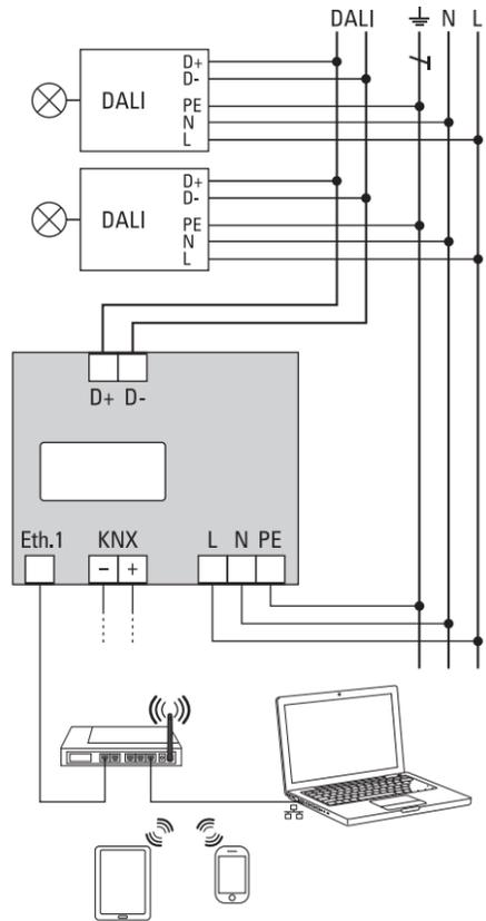
Nadat alle verbindingen tot stand zijn gebracht en de stroomtoevoer is ingeschakeld, verschijnen de productnaam en de firmwareversie op het display. Nu kunnen de inbedrijfstelling van de DALI-lijn en het programmeren met ETS worden gestart.
