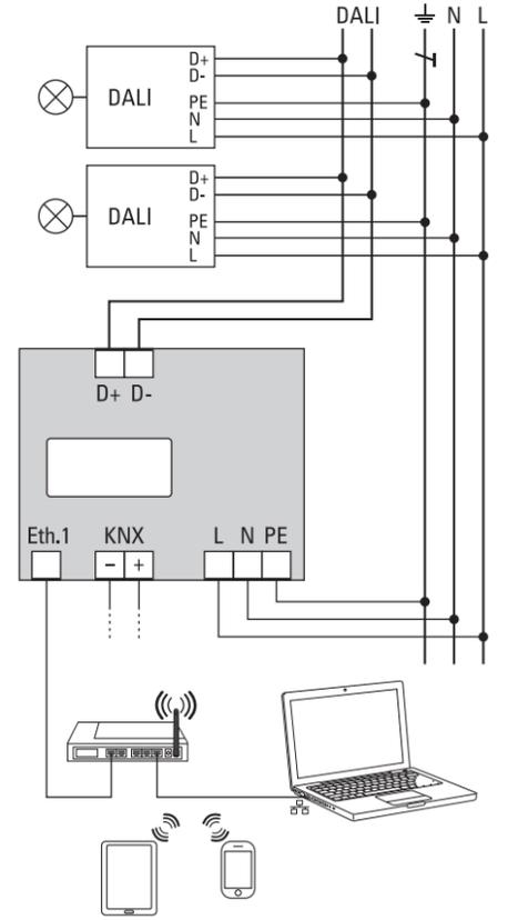
Nach vollständigem Anschluss und dem Einschalten der Versorgungsspannung werden im Display die Produktbezeichnung und die Firmwareversion angezeigt. Die Inbetriebnahme der DALI-Linie und die Programmierung mit der ETS können nun erfolgen.
