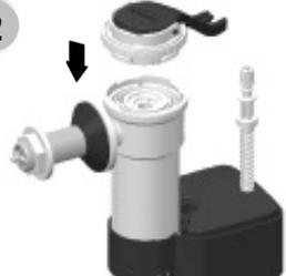
Mettre en place l'écrou de la tête de robinet .
