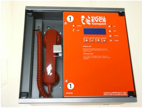
1. Dévisser les 2 vis du capot pour ouvrir l'appareil.
