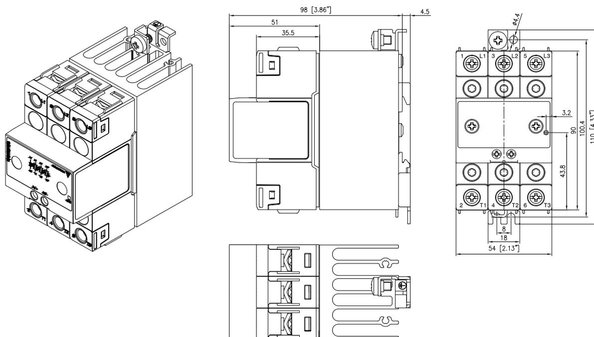
La tolérance de la largeur du logement doit être de +0.5 mm, -0mm...conformément à la norme DIN43880
