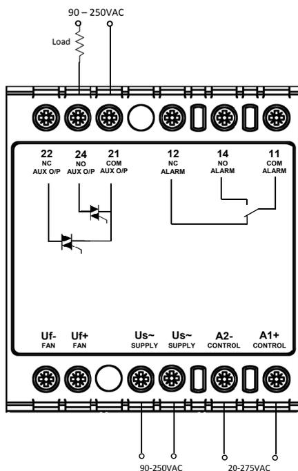
Connexion de la sortie auxiliaire NO (24-21) à une charge CA
