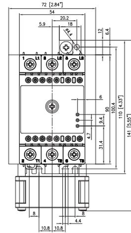
La tolérance de la largeur du logement doit être de +0.5 mm, -0mm...conformément à la norme DIN43880
