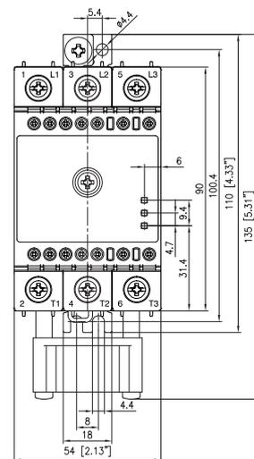
La tolérance de la largeur du logement doit être de +0.5 mm, -0mm...conformément à la norme DIN43880
