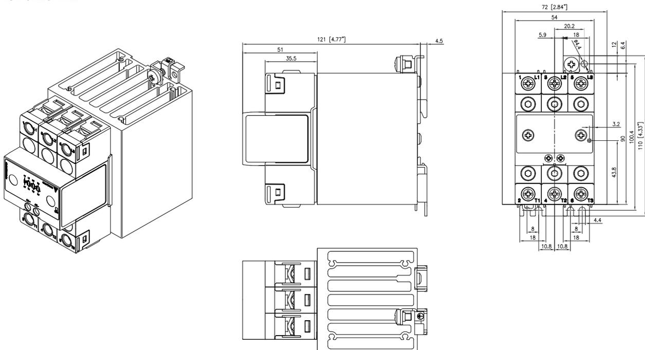
La tolérance de la largeur du logement doit être de +0.5 mm, -0mm...conformément à la norme DIN43880
