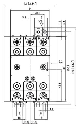
La tolérance de la largeur du logement doit être de +0.5 mm, -0mm...conformément à la norme DIN43880
