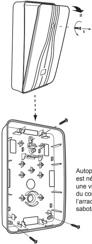
Autoprotection à l'arrachement : Il est nécessaire de fixer sur le mur une vis à tête plate en vis-à-vis du contact d'autoprotection à l'arrachement pour empêcher tout sabotage de celui-ci.
