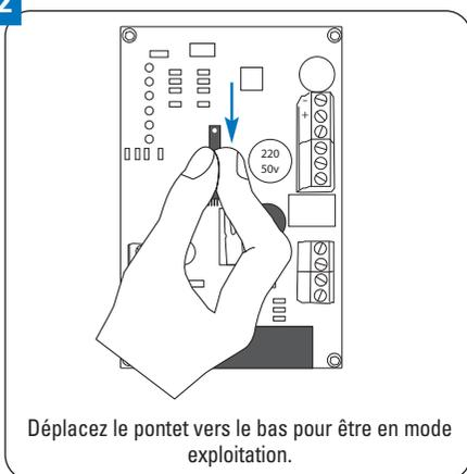
Déplacez le pontet vers le bas pour être en mode exploitation.
