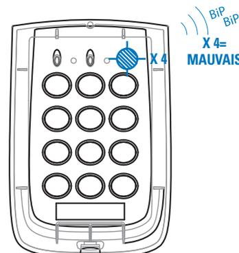
En cas de séquence incorrecte, le clavier génère quatre bips et quatre clignotements de led jaune.
