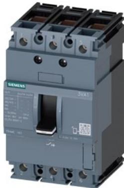
Disjoncteur 3VA1 CEI cadre 160 classe de coupure M Icu=55kA à 415V 3 pôles, protection des installations TM210, FTFM, In=160A protection contre les surcharges Ir=160A à réglage fixe protection contre les courts-circuits Ii=10 x In raccordement par bornes
