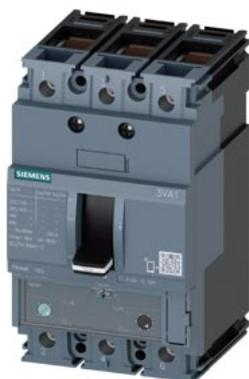
Disjoncteur 3VA1 CEI cadre 160 classe de coupure M Icu=55kA à 415V 3 pôles, protection des installations TM240, ATAM, In=160A protection contre les surcharges Ir=112A...160A protection contre les courts-circuits Ii=5...10 x In raccordement par bornes
