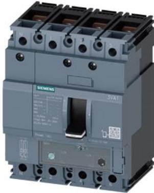
Disjoncteur 3VA1 CEI cadre 160 classe de coupure M Icu=55kA à 415V 4 pôles, protection des installations TM240, ATAM, In=160A protection contre les surcharges Ir=112A...160A protection contre les courts-circuits Ii=5...10 x In protection du neutre 100% plage de raccordement par vis
