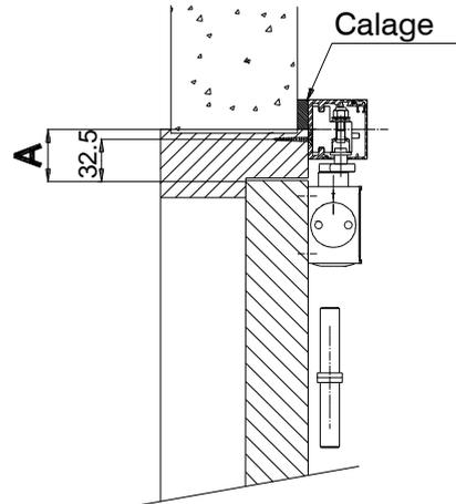
Si A est inférieur à 35mm, prévoir un montage avec 2 platines support dormant étroit.
