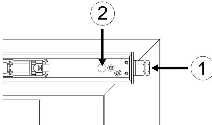
2/ Raccorder l'alimentation des modules d'arrêt et les contacts de position comme sur le schéma suivant :
