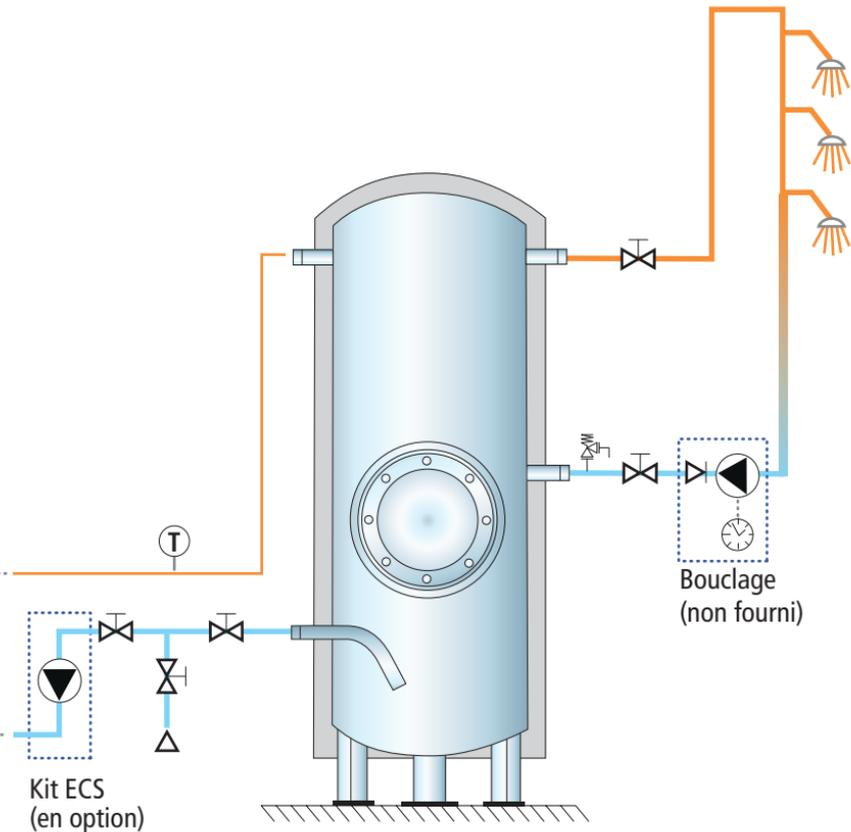
Schéma aval d'installation en semi-instantanée
