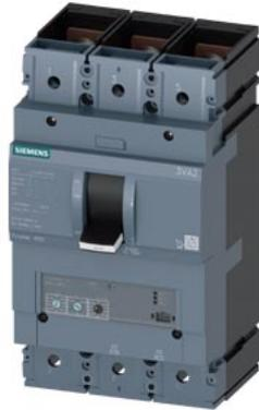
Disjoncteur 3VA2 CEI Frame 400 classe de coupure M Icu=55kA à 415V 3 pôles, protection de moteur ETU350M, LSI, In=250A protection contre les surcharges Ir=100A...250A protection contre les courts-circuits Isd=3...15 x Ir, li=15 x In plage de raccordement par vis
