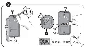
**②** Tracez et percez les trous D1, D2 et D3. Fixez le socle avec les vis V1, V2 et V3.
