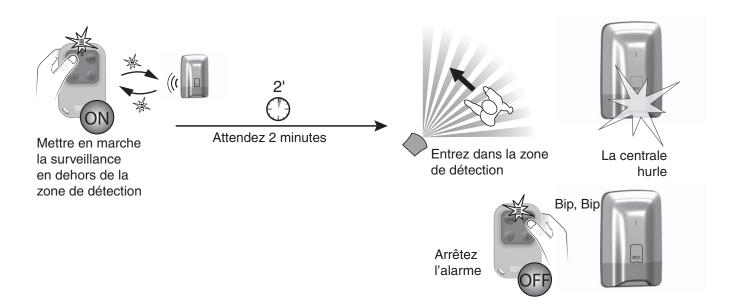
A chaque mise en marche ou arrêt du système, la centrale émet une série de bips, indiquant qu'un événement (ici la détection de mouvement) s'est produit. Vous pouvez le consulter sur un clavier tactile.
