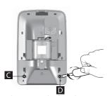
Remontez le socle sur la patte de fixation et fixez-le avec les vis (C et D).
