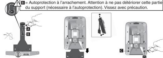
Fixez au mur (vis A et B) le support de fixation (ne pas mettre les vis C et D à cette étape).
