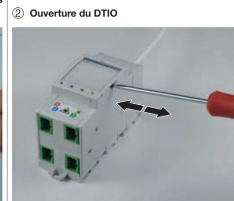
Enfoncer un tournevis plat dans la fente en haut du volet puis relâcher, le volet reculera avec le tournevis.
