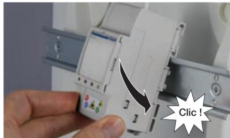
Remonter le volet sur le DTIO puis le reclipser sur le rail DIN dans le coffret de communication.
