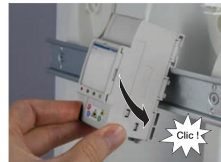
Remonter le volet sur le DTIO puis le reclipser sur le rail DIN dans le coffret de communication.
