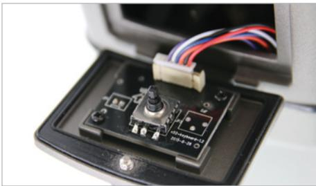
Réglage de l'OSD et basculement en mode CCTV via la carte électronique située dans la caméra.
