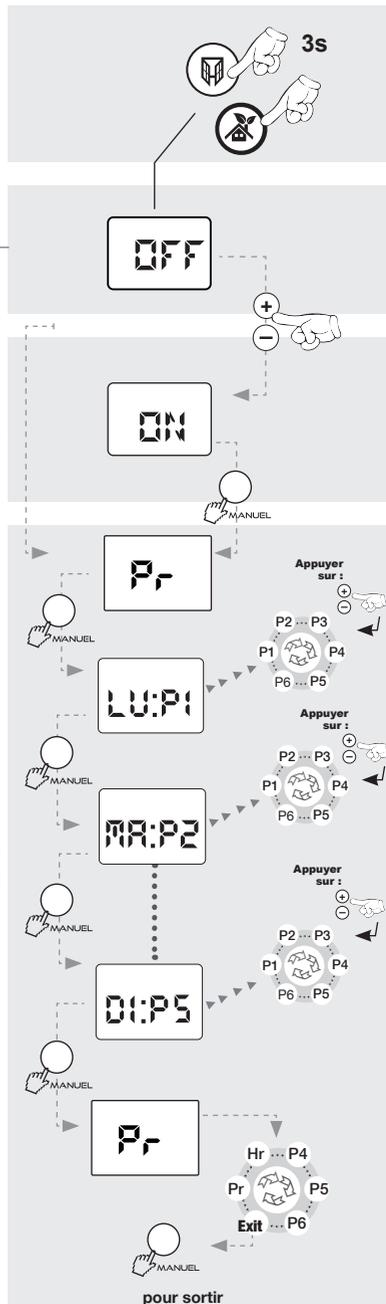
**i** Ce mode permet le fonctionnement automatique de votre appareil de chauffage soit en consigne **CONFORT**, soit en consigne **ECO**.
