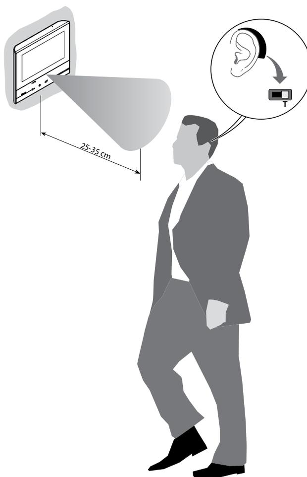
Pour garantir un bon accouplement magnétique entre PI et appareil acoustique, il est recommandé de se placer face au dispositif à une distance de 25-35 cm. Il est rappelé que la présence de métal et de bruit de fond généré par des appareillages électriques/électroniques (ex. ordinateurs) peut compromettre la qualité et les performances du dispositif d'accouplement.
