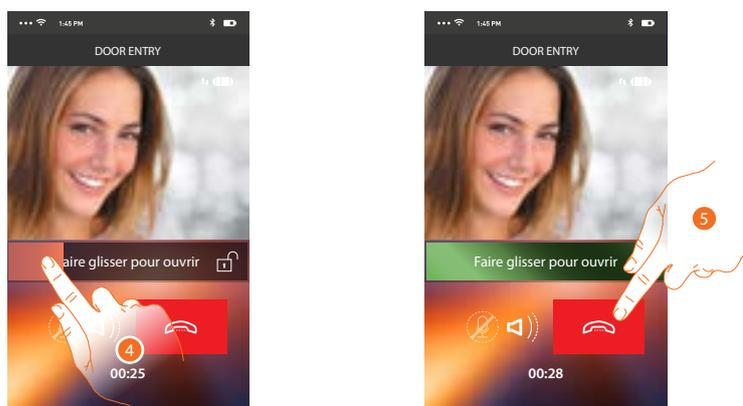
4. Il est en outre possible d'ouvrir la serrure du Poste externe dont provient l'appel, en glissant l'interrupteur ; quand elle devient verte, la serrure est activée ; si elle reste rouge, cela indique que la commande n'a pas été correctement effectuée.
