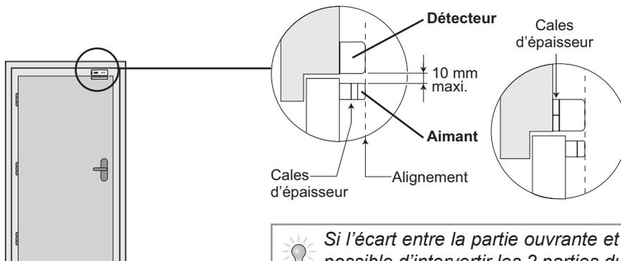
Utiliser une ou plusieurs cales d'épaisseur fournies dans l'emballage pour effectuer le réajustement du porte aimant et /ou du détecteur.
