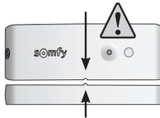
Placer le détecteur à l'intérieur de l'habitation **sur le dormant de la partie ouvrante**, soit horizontalement, soit verticalement, du côté ouvrant (à l'opposé des gonds).
