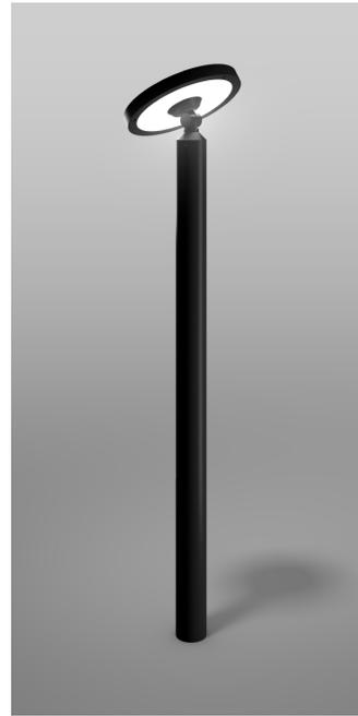
Borne à enterrer en continu. Corps en aluminium injecté traité époxy. Tête du luminaire pivotante. Diffuseur en matière synthétique (polycarbonate) opalin. Appareillage intégré.
