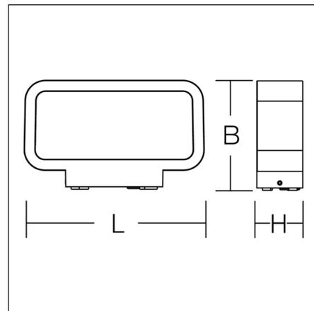
Applique. Corps en aluminium injecté traité époxy. Diffuseur en matière synthétique (polycarbonate) opalin. Diffusion lumineuse bilatérale. Appareillage intégré.
