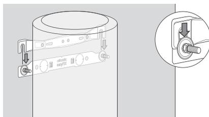
L'utilisation d'un trépied est obligatoire s'il s'agit d'un mur non porteur (ne pouvant pas supporter le poids du ballon rempli). Dans ce cas, une fixation du chauffe-eau au mur est obligatoire, soit avec l'étrier supérieur, soit avec la patte de fixation (qui permet une intégration dans un placard de dimensions intérieures à 600 x 600 mm).
