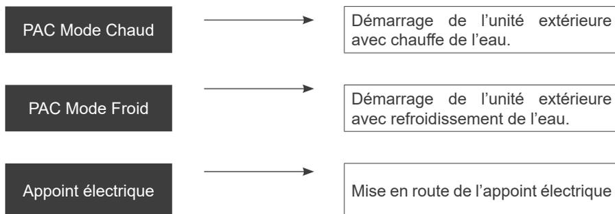
En mode test, PAC mode chaud, la pompe à chaleur démarre, 3 minutes après la mise sous tension, seulement si les conditions suivantes sont remplies :
