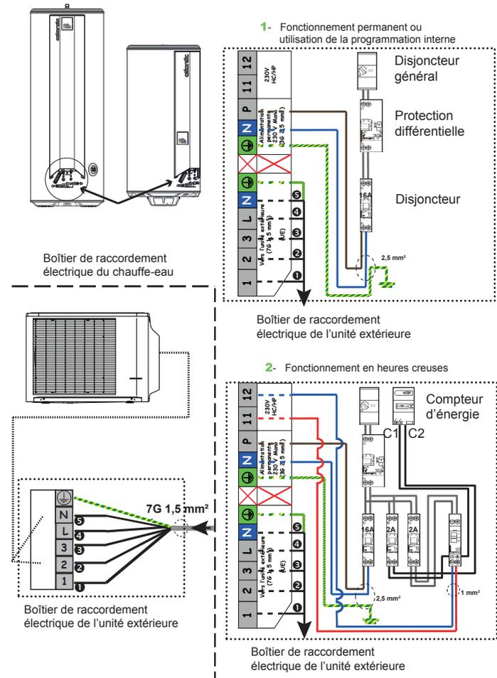
**NOTA :** Dans certains cas où il est difficile d'établir une deuxième ligne d'alimentation, il est possible de remplacer le contact heures creuses/heures pleines d'EDF par l'horloge intégrée à l'appareil (plage de fonctionnement Prog). Il faut alors la programmer suivant la tarification en vigueur sur le lieu d'installation (Réaliser le schéma 1).
