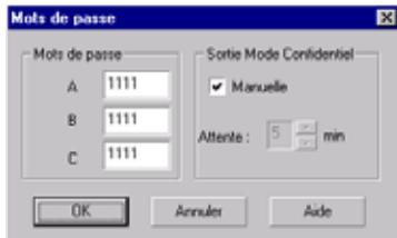
Trois mots de passe A, B et C peuvent être configurés. Chaque mot de passe est composé de quatre caractères ASCII ([0..9]+[A..Z]). Ces trois mots de passe sont configurés par défaut à "1111".
