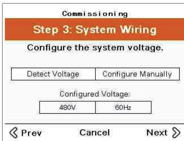
**Detect Voltage** détectera automatiquement la tension nominale du système.
