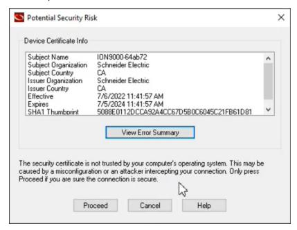
ION Setup stocke le certificat lorsque vous utilisez le mode Réseau. En mode Appareil unique, vous devez accepter le certificat à chaque fois que vous vous connectez à un appareil à l'aide de Secure ION.
