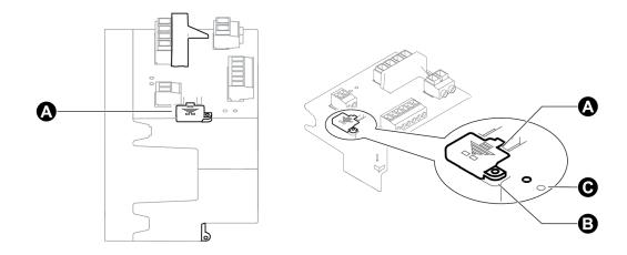
A Couvercle avec commutateur de verrouillage de facturation
