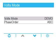
4. Appuyez sur pour changer le chiffre en surbrillance (0-9). Appuyez sur pour passer au chiffre suivant. Appuyez sur pour entrer votre mot de passe à l'aide du clavier à l'écran. L'écran de configuration **Mode volts** s'affiche.
