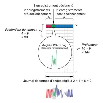
Journal de formes d'ondes défini pour la capture d'onde étendue = [enregistrements avant déclenchement] + [enregistrement actuellement déclenché] + [enregistrements après déclenchement]. Le total des captures d'onde enregistrées dans cet exemple est de 2 + 1 + 6 = 9.
