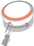
**FR** Désactivez l'autoprotection (menu «Mes équipements» de l'application). Retirez la sirène fixée au mur à l'aide d'un tournevis (maintenir appuyé et tourner la sirène dans le sens de la flèche). Ouvrez le capot des piles et procédez au remplacement (4 x 1,5 V alcaline D).
