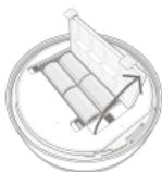
**IT** Disattivare la autoprotezione (menu «Le mie attrezzature» dell'applicazione). Rimuovere la sirena fissata al muro mediante un cacciavite (tenere premuto e girare la sirena nel senso della freccia). Aprire il coperchio del vano batterie e procedere alla sostituzione (4 da 1,5 V Alcaline D).
