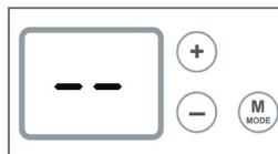
Pour l'arrêt chauffage de l'appareil, appuyez sur la touche **MODE** jusqu'à la position veille.
