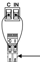
Jusqu'à deux capteurs de mouvement connectés en parallèle sur la même entrée du dispositif
