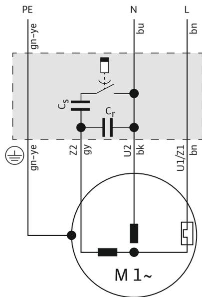
Fig. 7: Schéma de raccordement du moteur monophasé
