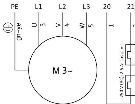
Fig. 8: Schéma de raccordement du moteur triphasé
