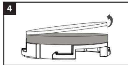
Enlever le film de protection blanc de l'adhésif. **Vérifier l'orientation souhaitée du détecteur avant de coller le disque de fixation au plafond/mur.**
