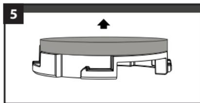
Coller le socle de fixation sur le mur ou le plafond sans le détecteur de fumée.
