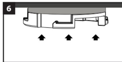
Maintenir fermement le socle de fixation contre le mur ou le plafond en exerçant une forte pression avec le pouce pendant 10 secondes.
