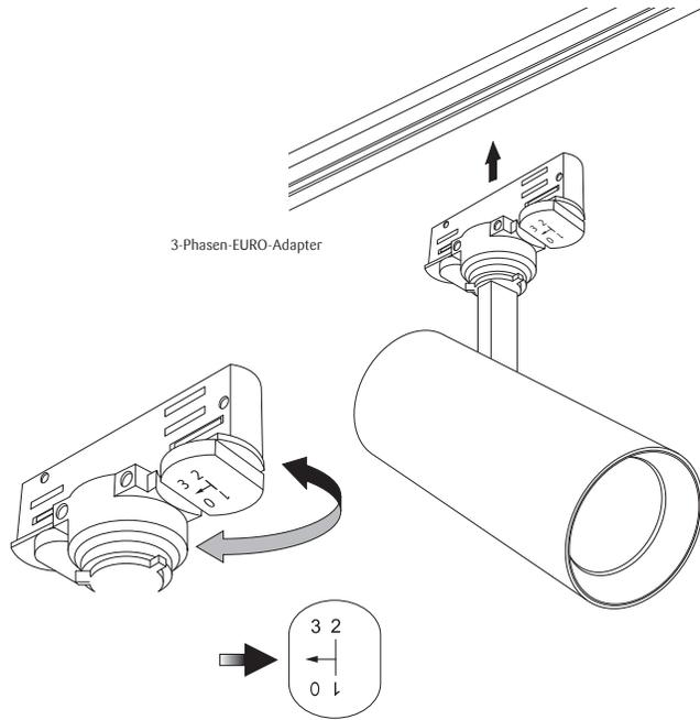
**Hinweis:** DALI Eutrac 3-Adapter kann nur in einer Richtung eingesetzt werden. Achten Sie auf die Führungsnut. Bei der Montage von DALI Versionen ist darauf zu achten, dass der Strahler gerade von unten nach oben angesetzt wird, um ein Verbiegen der Datenabgriff-Stifte zu vermeiden.
