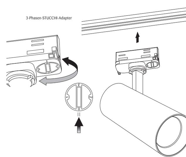
**Hinweis:** non dim/DALI Global pulse-Adapter kann nur in einer Richtung eingesetzt werden. Achten Sie auf die Führungsnut.
