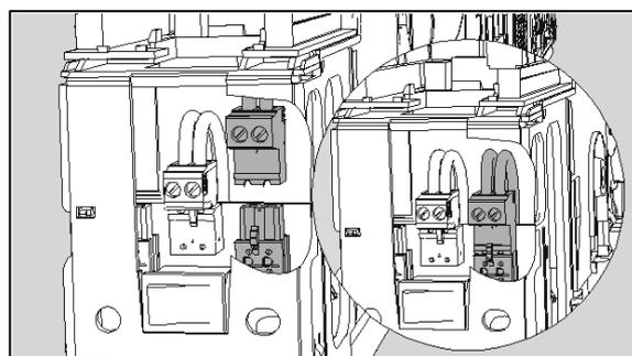
3- Raccorder l'interrupteur de fonction
