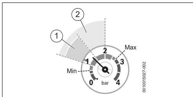
Fig. 2 Manomètre pour le contrôle de la pression de service
