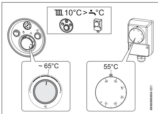
Fig. 8 Exemple de réglage de l'aquastat et du thermostat de l'appareil (chaudière)
