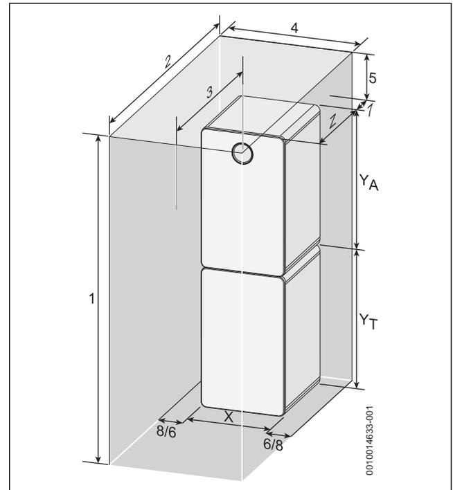
Fig. 12 Dégagements pour un appareil monté au-dessus du ballon ECS
