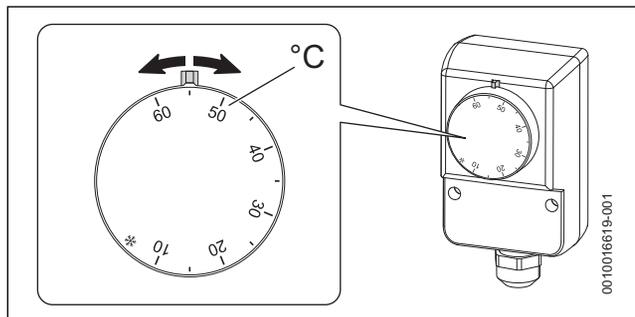
Fig. 7 Réglage de la température de l'aquastat
