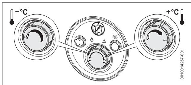
Fig. 4 Réglage de la température
