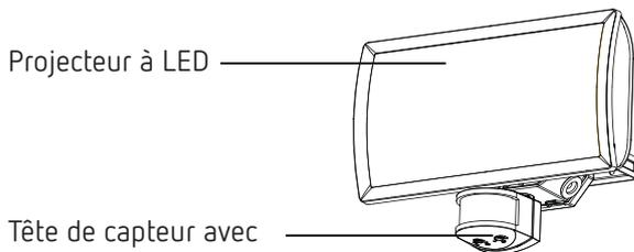
Tête de capteur avec 2 potentiomètres pour le réglage de la durée (min) et de la luminosité (lux)
