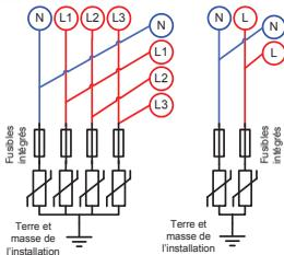
Le raccordement s'effectue selon les recommandations de la norme NFC15-100. Les schémas ci-contre illustrent le déconnecteur intégré au parafoudre pour donner la priorité à la continuité de service. Il convient de limiter au maximum les longueurs de connexion afin de préserver l'efficacité du parafoudre (< 50 cm).
