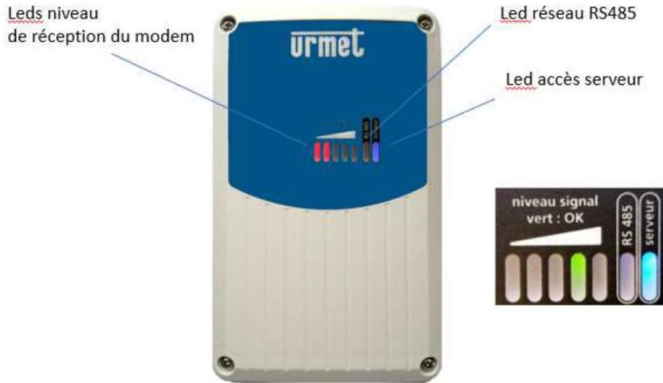
Pour réveiller le modem, choisir un nom sur la platine de rue et lancer l'appel ou appuyer sur le bouton « envoi sentinelle ». Sur le Modem, vérifier l'affichage des LED.
