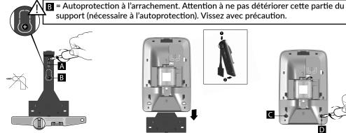
Fixez au mur (vis A et B) le support de fixation (ne pas mettre les vis C et D à cette étape).
