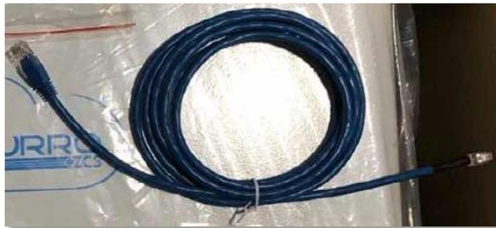
Figure 12 - Câble de communication entre l'onduleur et la batterie WeCo 4k4
