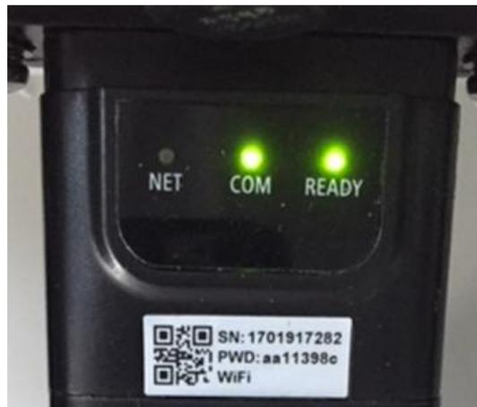
Figure 86 – État de communication irrégulière entre adaptateur et serveur à distance
