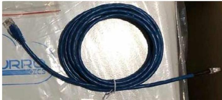
Figure 19 - Câble de communication entre l'onduleur et la batterie WeCo 4k4
