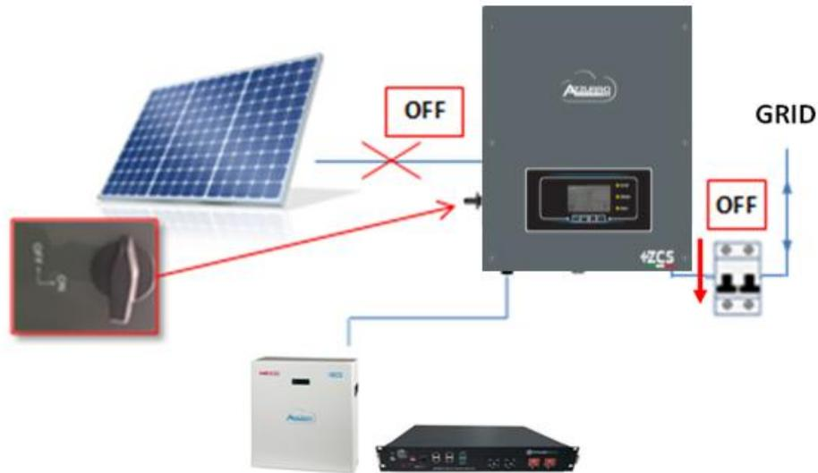
3. Allumer l'onduleur en relevant l'interrupteur AC.
