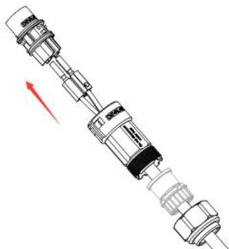
**Étape 5 :** Connecter la borne de charge au port de charge de l'onduleur et pousser la borne en avant jusqu'à entendre un « clic » indiquant que la connexion de la borne est terminée.
