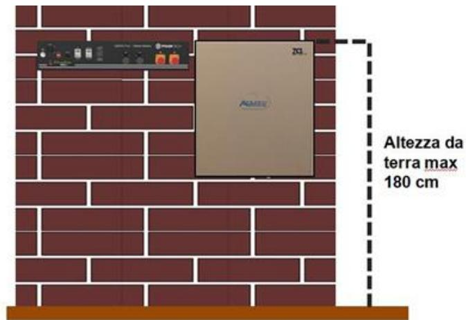
Figure 5 – Instructions pour l'installation de l'onduleur de stockage et des groupes de batteries
