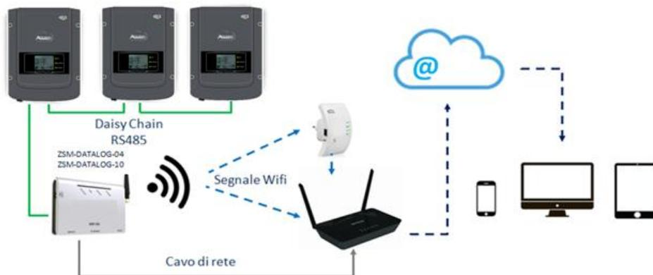
Figure 93 – Schéma de connexion du datalogger ZSM-DATALOG-04 / ZSM-DATALOG-10
