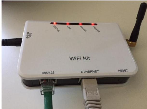
Figure 101 - Câble Ethernet connecté au datalogger
