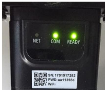
Figure 92 – État de communication irrégulière entre adaptateur et serveur à distance
