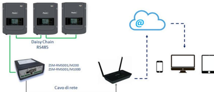
Figure 94 – Schéma illustrant le fonctionnement du datalogger ZSM-RMS001/M200 / ZSM-RMS001/M1000
