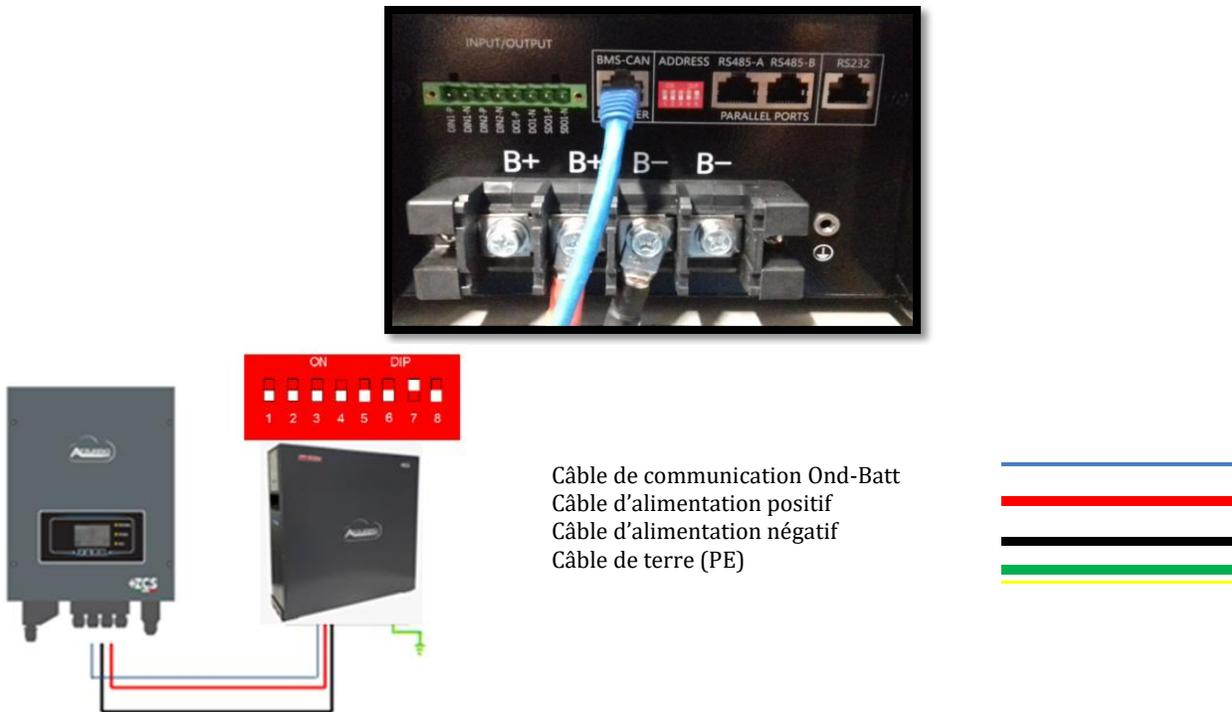
Figure 20 – Raccordement de la batterie WeCo 4k4 PRO
