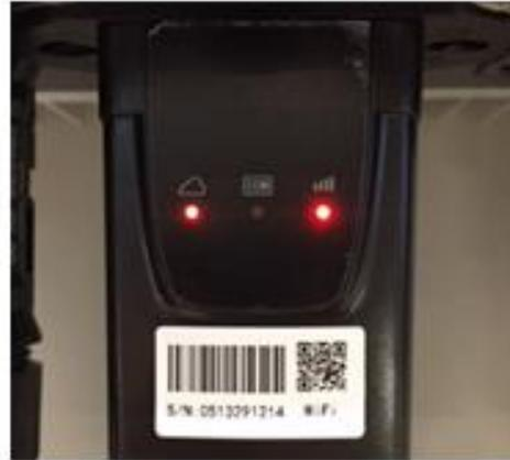
Figure 74 – État de communication irrégulière entre onduleur et Wi-Fi
