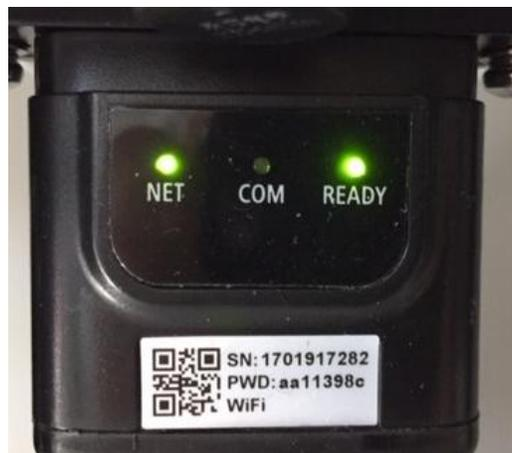
Figure 85 – État de communication irrégulière entre onduleur et adaptateur
