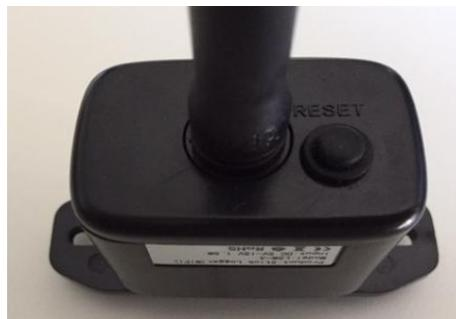
Figure 73 – Bouton de réinitialisation sur l’adaptateur Wi-Fi
