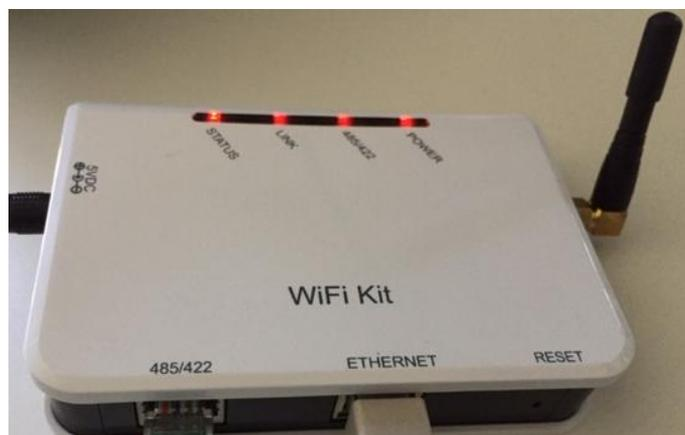
Figure 114 – LED qui indique la configuration correcte du datalogger
