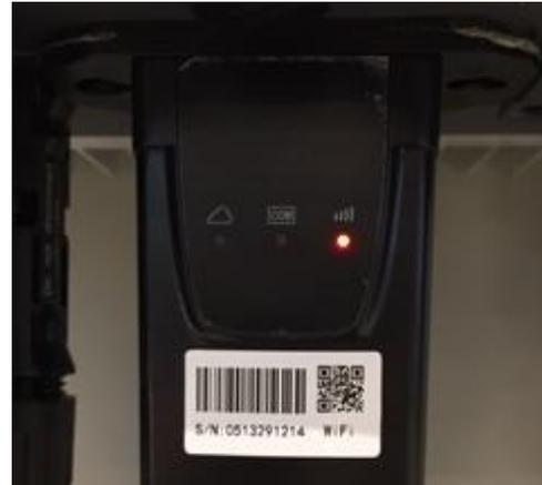
Figure 76 – État de communication irrégulière entre Wi-Fi et serveur à distance
