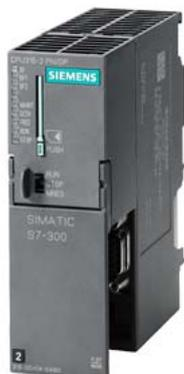
SIMATIC S7-300 CPU 315-2 PN/DP, Module unité centrale avec 384 Ko de mémoire de travail, 1. interface MPI/DP 12MBit/s, 2. interface Ethernet PROFINET, avec commutateur 2 ports, microcarte mémoire requise
