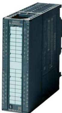
SIMATIC S7-300, sortie TOR SM 322, à séparation galvanique, 32DA, 24V CC, 0,5A, 1x 40 pôles, courant total 4A/groupe (16A/Baugruppe)
